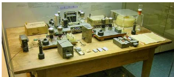
核分裂を発見した実験器具： ミュンヘンにおけるドイツ博物館
